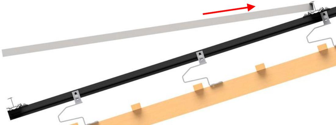
Figure 157: Insert module
